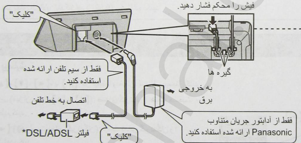
\*اگر سرویس DSL/ADSL دارید باید از فیلتر DSL/ADSL (ارائه نشده است) استفاده شود.
