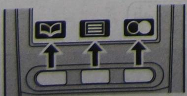
گوشی دارای ۳ کلید سافت می باشد. با فشار دادن یک کلید سافت، شما می توانید ویژگی را که درست در بالای آن بر روی صفحه نمایش نشان داده شده است را انتخاب نمایید.
